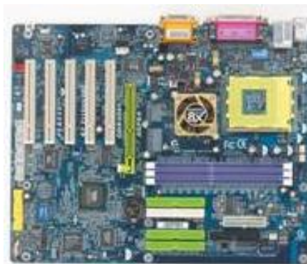
รูป 3.51 แสดงลักษณะของ Mainboard
