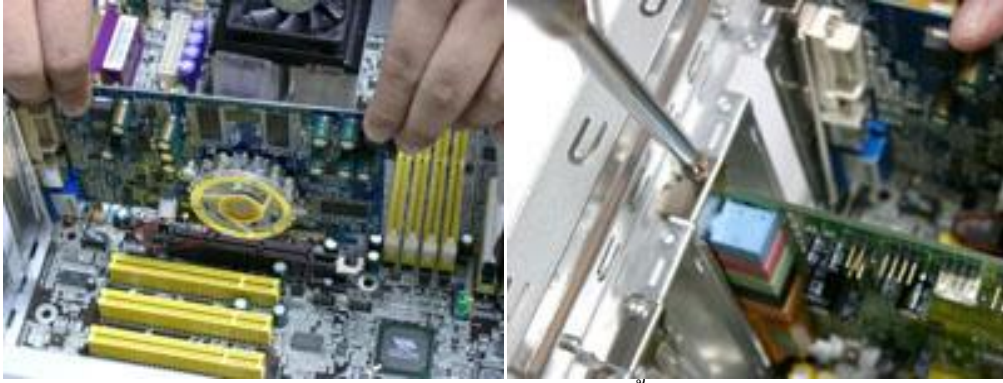
รูป 3.60 แสดงการติดตั้ง Card
