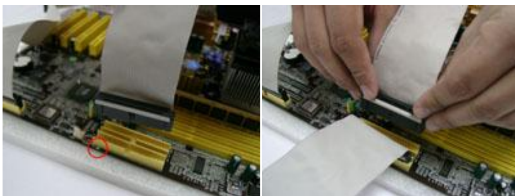
รูป 3.54 แสดงการติดตั้งสายแพลงบน Mainboard
