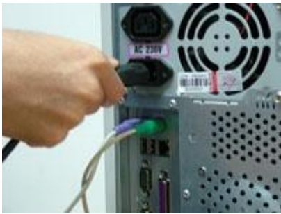
รูป 3.64 แสดงการต่อสายไฟ
