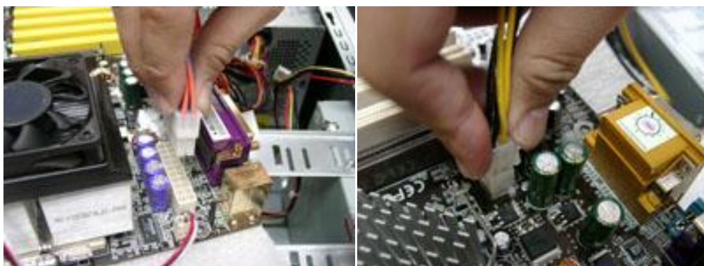
รูป 3.53 แสดงการติดตั้งสาย Power
