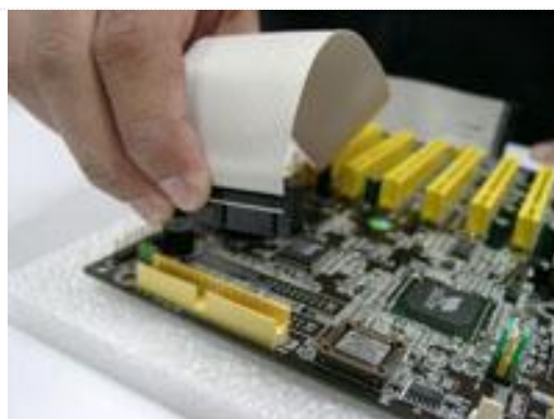
รูป 3.55 แสดงการติดตั้งสำหรับ Floppy Disk Drive
