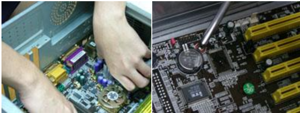
รูป 3.52 แสดงการติดตั้ง Mainboard
