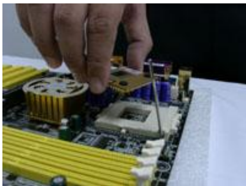
รูป 3.41 แสดงนำ CPU มาวางบน Socket
